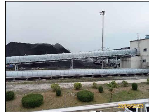
รูปที่ 2-1 สายพานลำเลียงระบบปิดบริเวณลานกองถ่านหินของโครงการฯ
